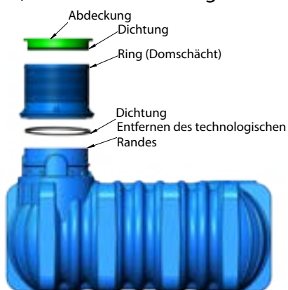
Abb. 18: Möglichkeit des Ringeinbaus
