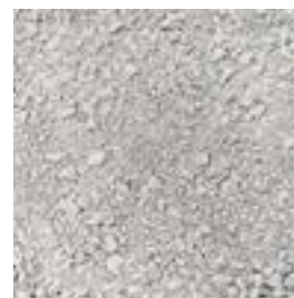
ZERKLEINERTES MATERIAL: BRECHGUT Mischung Fraktion 0-16 mm
