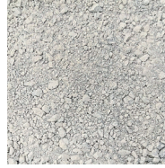
**KLEINGESCHLAGENES MATERIAL: SCHOTTER Fraktionen 0-16 mm
